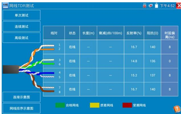
**高级测试：**测试线缆状态、长度和衰减、反射率、阻抗和时延偏移等参数。
