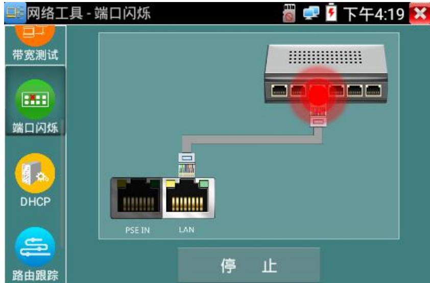
**实用性：**工程人员要检修插在交换机上的网线时，不能随意拔网线，如果拔错线会造成在用网络中断。用仪表在网线的另一端发送信号，对应的交换端口会按固定的频率闪烁，可明显区分其它在用的端口，快速定位该交换机端口，避免工程人员拔错线。
