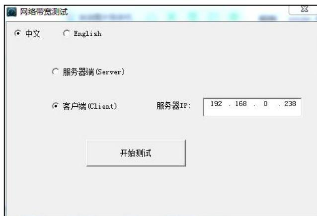
仪表作为测试端，仪表的IP地址为：192.168.0.39，与电脑服务器端是同一网段不同IP地址。在仪表的测试端填入服务器端的IP地址：192.168.0.238，点击“开始测试”进行网络带宽测试。
