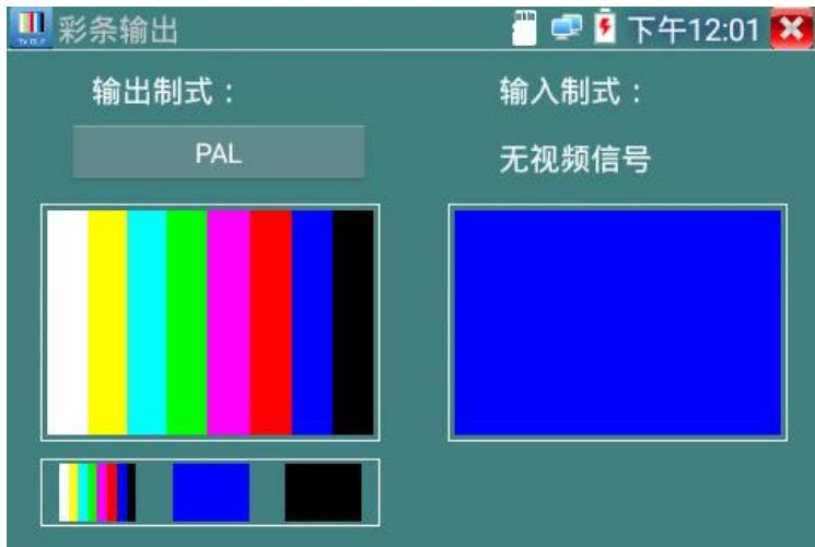
用手指向左右滑动或轻触下面的**彩条、蓝色、黑色**，可选择相应的图像输出；在屏幕上连击两次，全屏显示和输出。
