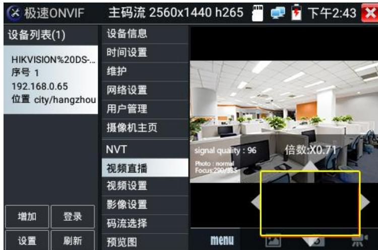
图像放大状态时，如果不用触摸操作，也可按键操作。按 图像放大；按 图像缩小；按上下左右方向键，移动图像。
