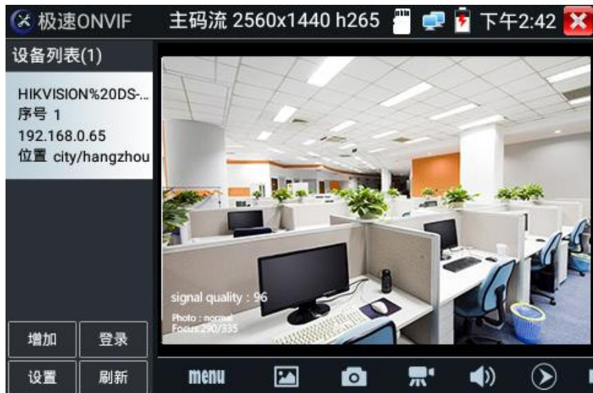
**拍照:** 轻触底部工具栏的“拍照”功能，仪表截取当前显示的图像，并存储于SD卡中。
