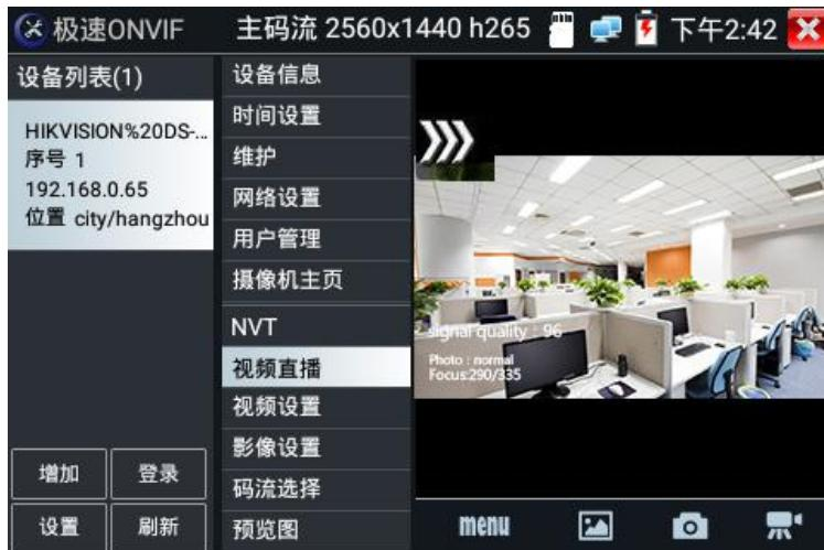
**视频设置：**点击“视频流”，可进行网络摄像机的解码分辨率设置，设置后，点击“应用”保存。
