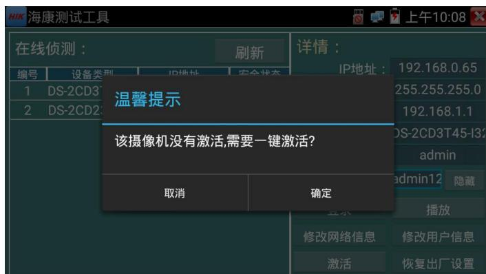
2. **输入激活密码：**按要求输入新的密码，点击“确定”可激活摄像机。
