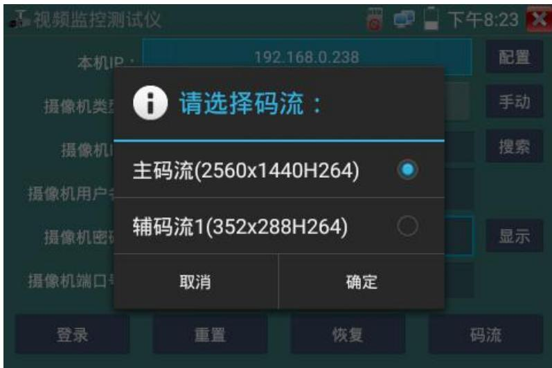
**摄像机IP地址：**输入IP网络摄像机的IP地址。点击“配置”添加不同网段的IP地址，仪表可测试多网段的网络摄像机。
