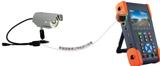
**注：**对于不提供外接电源的IP网络摄像机，因为它只支持PoE供电功能，可通过仪表的LAN端口为该网络摄像机提供PoE供电，供电时必须断开网络交换机与仪表的连接，即仪表的PSE端口不能连接任何网线。
