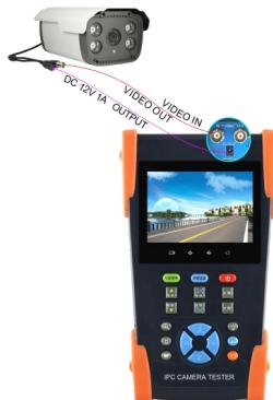
12V供电输出电压大小及功率值，可在PoE电压测量功能中查看。
