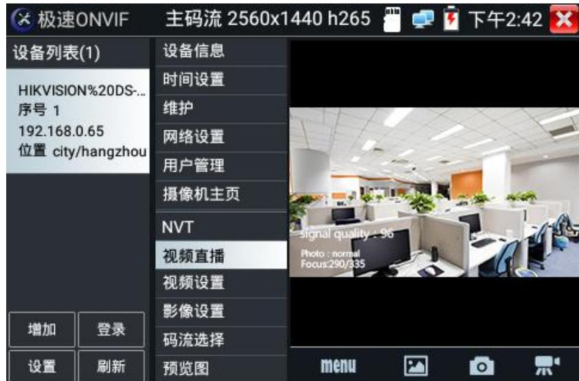
**云台控制：**手指在图像显示区域向左、右、上、下滑动，以及两手指向外滑动扩大、向内缩小，网络球机做相应的转动动作。图像显示区域的左上角，显示云台转动方向。
