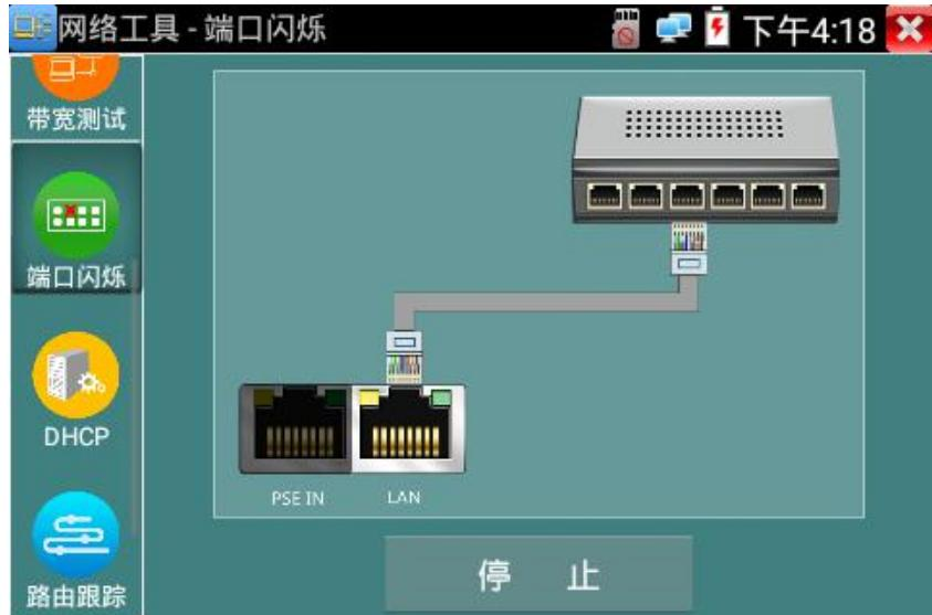
仪表开始发送闪烁信号之前，与仪表连接的端口建立连接通信，正常通信时，仪表屏幕显示的交换机端口图标会按一定频率闪烁；如果无法正常通信（如网线没接好），交换机端口无任何变化。
