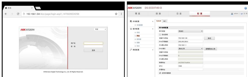
网络摄像机和仪表必须同一网段，浏览器才能登陆网络摄像机。如果通过浏览器修改网络摄像机的地址后，网络摄像机的IP地址与仪表地址不同网段，请等待会话结束并点击
