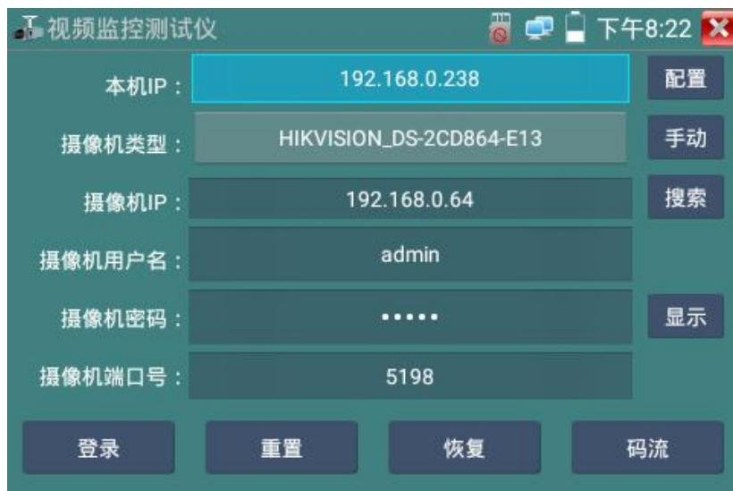
**本机IP：**指本仪表的IP地址，仪表支持多网段的IP摄像机测试。点“配置”，进入仪表系统设置的“IP设置”界面，设置本仪表的IP地址，可在高级选项中添加不同网段的IP地址，点“设置”保存，提示设置成功，点
