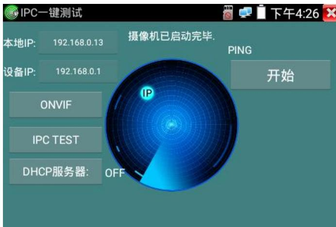
**本机 IP:** 仪表当前的 IP 地址，在搜索到设备 IP 的同时，仪表将自动修改本机 IP 与设备 IP 同一网段。
