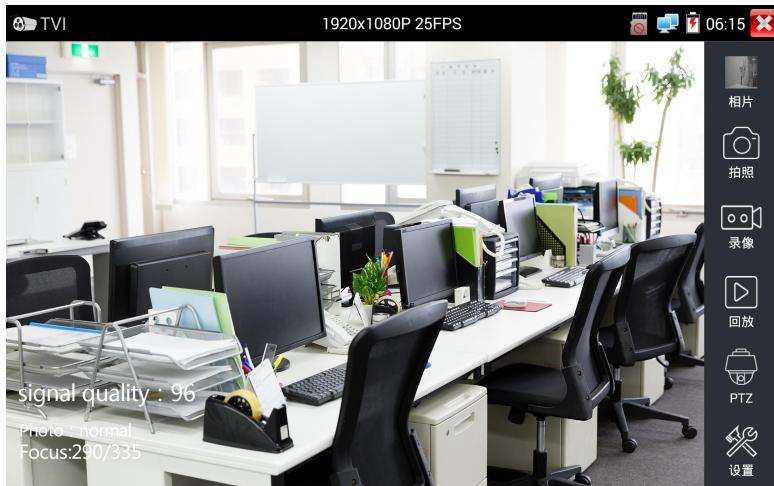
仪表接收HD TVI图像时，上面菜单条显示该图像的分辨率。手指快速连续两次轻触屏幕，全屏显示图像。仪表支持分辨：
