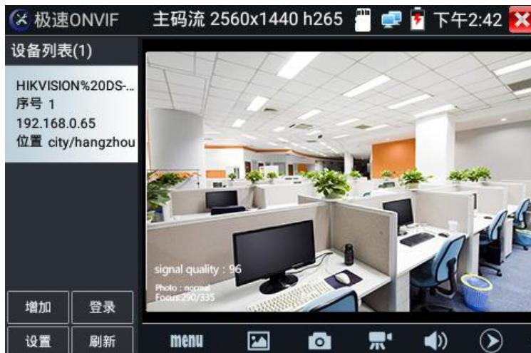
**视频直播：**点击“视频直播”，可直播网络摄像机的图像。双击图像显示区域，仪表全屏显示图像；全屏显示时，双击屏幕返回原来状态。
