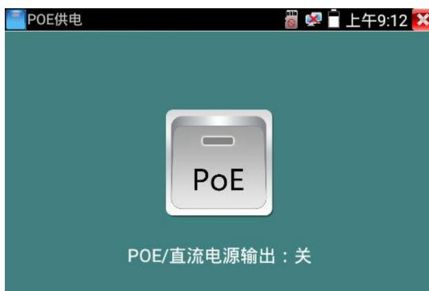
仪表直流电源输出开启，退出电源输出界面后，PoE电源处于开启状态，仪表上面的菜单条一直悬浮“48V已打开”，直到仪表休眠或进入电源输出功能界面点击关闭电源输出。
