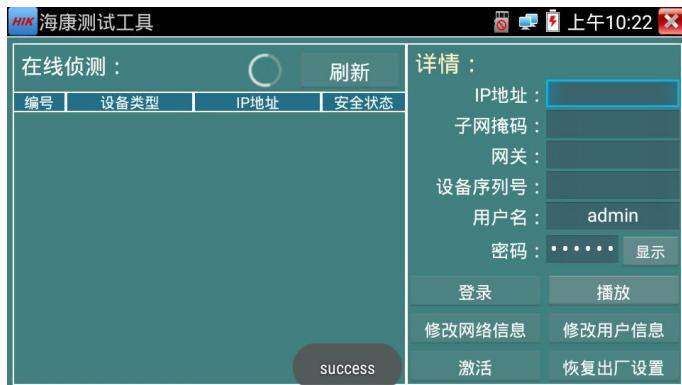
已激活的摄像机，需要登录之后才能进行其他操作。登录时，在左边“在线侦测”栏目选中摄像机，输入正确的用户名密码之后点击“登陆”。
