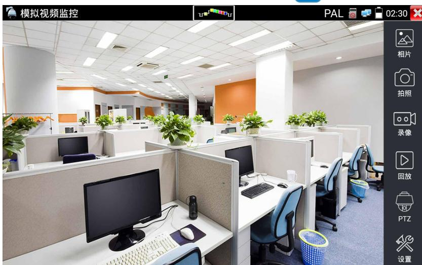
进入模拟视频监控测试界面，当有图像输入时，显示摄像机送过来的图像。在接收到摄像机或快球的图像时，可轻触上面菜单条的 进行视频电平测量；轻触右边“拍照”、“录像”、“相片浏览”、“录像回放”、“PTZ云台控制”、“色彩及存储设置”工具栏功能，进行相关操作。
