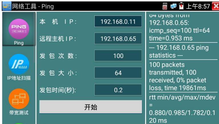
**实用性：**维护网络设备时，最常用的方法是用PING测试该设备工作是否正常、IP地址设置是否正确，IP摄像机或其他网络设备可以被PING得通，才能进行正常网络通信。PING测试时，第一个包可能会丢包，这是正常现象。
