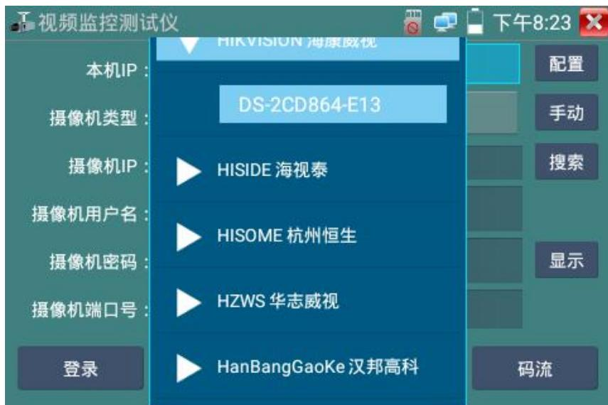
**码流：**使用RTSP码流播放摄像机图像，可选主码流或子码流进行图像测试。（如果摄像机RTSP服务未开启或没有此服务，将提示“智能匹配类型错误，请切换为手动选择类型”）
