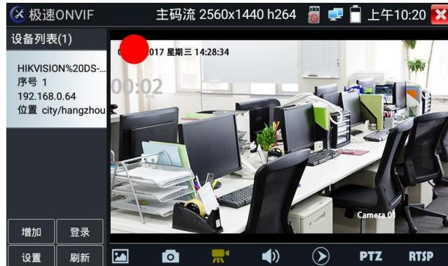
**回放：**轻触**底部**工具栏的“回放”图标，显示录像文件，双击该文件进行播放。轻触右上方的**X**关闭并返回上层菜单。
