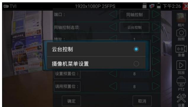
输入调用球机菜单的地址码，参数设置完成后，直接按键盘“确认”或点击屏幕中的“确认键”，
