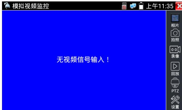
**⚠** 模拟视频输入时，因分辨率是720\*480，所以视频图像放大后图像不太清晰，这是正常现象；而在网络数字视频输入时，视频图像分辨率可达1280\*960，图像放大后图像依然很清晰，施工人员对网络摄像机安装位置的确认，非常有帮助。
