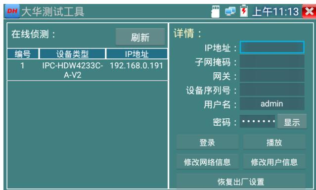
选中“在线侦测”栏目的摄像机，如果摄像机支持非验证方式登陆，无需登陆，直接点击播放，可观看摄像机图像。
