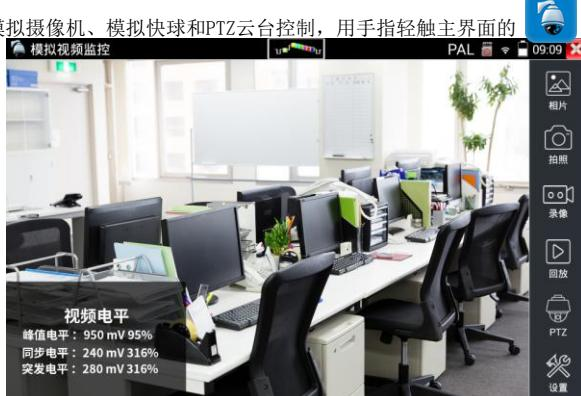
进入模拟视频监控测试界面，当有图像输入时，显示摄像机送过来的图像。轻触右边“拍照”、“录像”、“相片浏览”、“录像回放”、“PTZ云台控制”、“色彩及存储设置”工具栏功能，进行相关操作。
