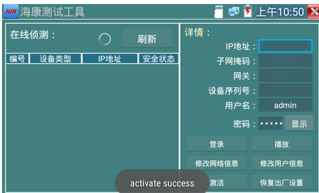
已激活的摄像机，需要登录之后才能进行其他操作。登录时，在左边“在线侦测”栏目选中摄像机，输入正确的用户名密码之后点击“登陆”。
