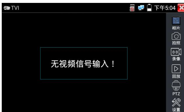
仪表接收HD TVI图像时，上面菜单条显示该图像的分辨率。手指快速连续两次轻触屏幕，全屏显示图像。仪表支持分辨：
