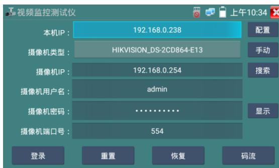
**本机IP：**指本仪表的IP地址，仪表支持多网段的IP摄像机测试。点“配置”，进入仪表系统设置的“IP设置”界面，设置本仪表的IP地址，可在高级选项中添加不同网段的IP地址，点“设置”保存，提示设置成功，点
