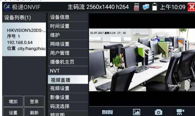
**云台控制：**手指在图像显示区域向左、右、上、下滑动，以及两手指向外滑动扩大、向内缩小，网络球机做相应的转动动作。图像显示区域的左上角，显示云台转动方向。
