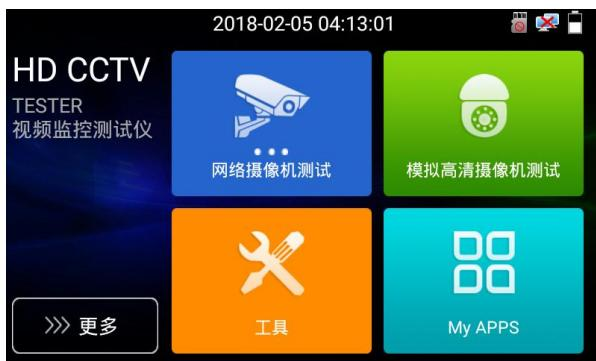
打开功能项，点击右下角手指图标变黄色时，长按功能图标，可将功能图标移动到其他项。不点击该图标，长按应用图标，可在文件夹内部移动，重新排列。
