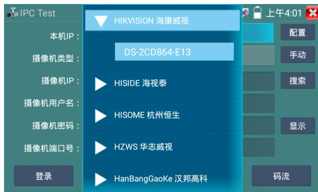
**码流：** 使用RTSP码流播放摄像机图像，可选主码流或子码流进行图像测试。（如果摄像机RTSP服务未开启或没有此服务，将提示“智能匹配类型错误，请切换为手动选择类型”）
