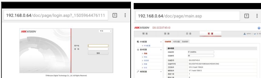
网络摄像机和仪表必须同一网段，浏览器才能登陆网络摄像机。如果通过浏览器修改网络摄像机的地址后，网络摄像机的IP地址与仪表地址不同网段，请等待会话结束按RETRUN退出浏览器，在主菜单界面点击“系统设置”修改仪表的IP地址与网络摄像机同一网段，才能对网络摄像机进行测试操作。
