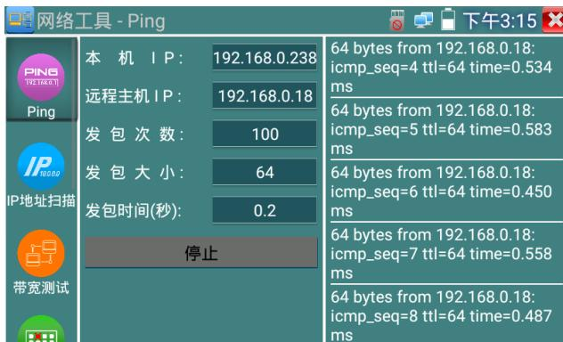
**实用性：**维护网络设备时，最常用的方法是用PING测试该设备工作是否正常、IP地址设置是否正确，IP摄像机或其他网络设备可以被PING得通，才能进行正常网络通信。PING测试时，第一个包可能会丢包，这是正常现象。
