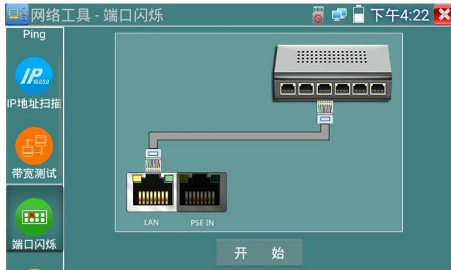
仪表开始发送闪烁信号之前，与仪表连接的端口建立连接通信，正常通信时，仪表屏幕显示的交换机端口图标会按一定频率闪烁；如果无法正常通信（如网线没接好），交换机端口无任何变化。
