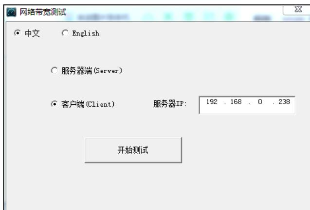
仪表作为测试端，仪表的IP地址为：192.168.0.238，与电脑服务器端是同一网段不同IP地址。在仪表的测试端填入服务器端的IP地址：192.168.0.234，点击“开始测试”进行网络带宽测试。
