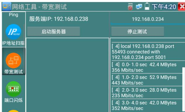
网络带宽测试，也可以用一个仪表和电脑进行测试。在电脑上安装网络带宽测试软件，作为测试端或服务器，与仪表进行对测。
