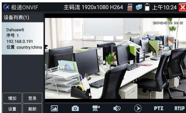
**视频直播:** 点击“视频直播”，可直播网络摄像机的图像。双击图像显示区域，仪表全屏显示图像；全屏显示时，双击屏幕返回原来状态。
