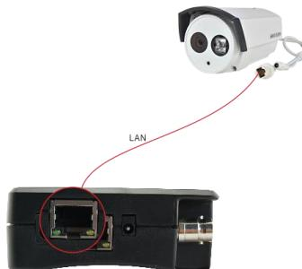
**注:** 对于不提供外接电源的IP网络摄像机,因为它只支持PoE供电功能,可通过仪表的LAN端口为该网络摄像机提供PoE供电。
