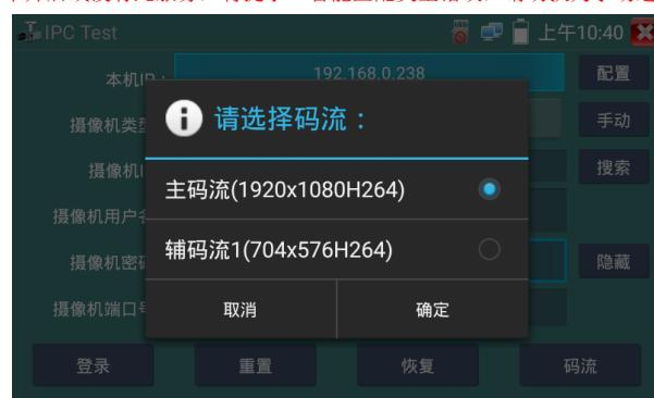
**摄像机IP地址：** 输入IP网络摄像机的IP地址。点击“配置”添加不同网段的IP地址，仪表可测试多网段的网络摄像机。点击“搜索”，可自动扫描IP网络摄像机的IP地址，找到IP地址后，显示在地址框中。建议仪表与IP网络摄像机直接连接，扫描出来的地址才是唯一的。如果仪表接入交换机中，会扫描出多个IP地址。
