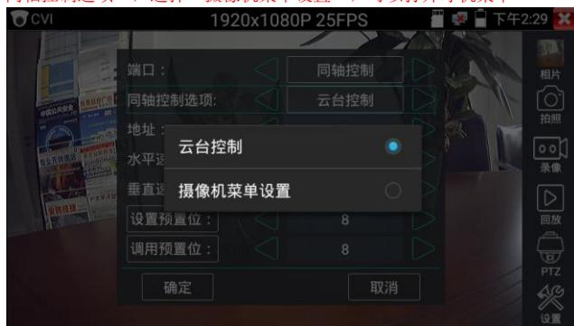
输入调用球机菜单的地址码，参数设置完成后，点击屏幕中的“进入菜单”，可调出球机主菜单。
