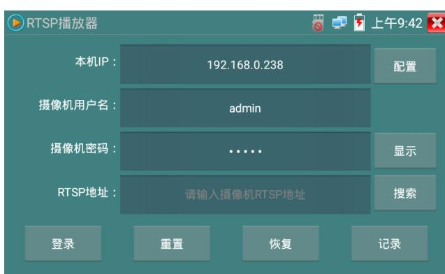
点击“RTSP 地址”后面的搜索，选中扫描到的摄像机的 IP 地址。仪表将扫描到网络摄像机的 RTSP 地址自动填入，客户也可以手动填入已知 RTSP 地址。
