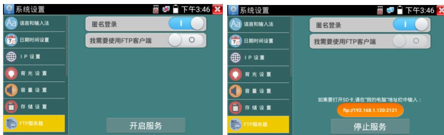
开启FTP服务后，在PC机的“计算机”栏中输入仪表显示的ftp地址（如：
