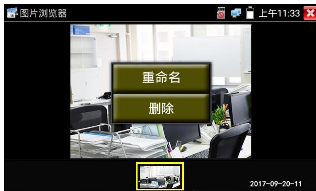
轻触右上角的 关闭相片浏览，回到视频监控测试状态。
