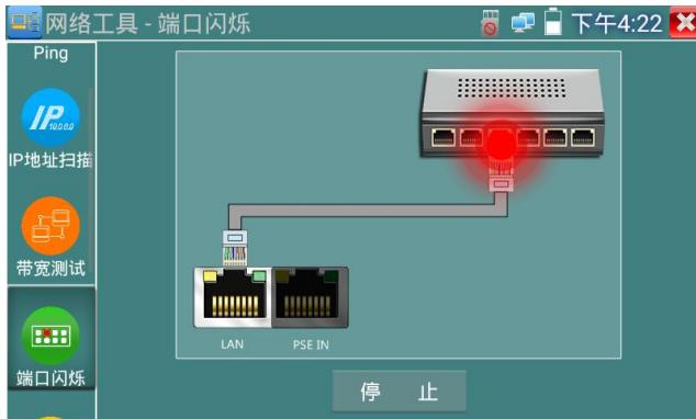
**实用性：**工程人员要检修插在交换机上的网线时，不能随意拔网线，如果拔错线会造成在用网络中断。用仪表在网线的另一端发送信号，对应的交换端口会按固定的频率闪烁，可明显区分其它在用的端口，快速定位该交换机端口，避免工程人员拔错线。
