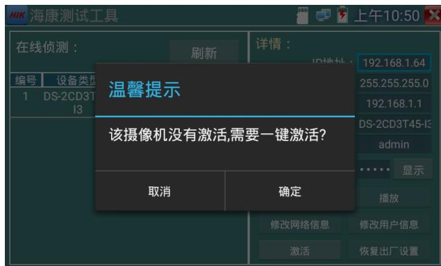
**2. 输入激活密码：**按要求输入新的密码，点击“确定”可激活摄像机。
