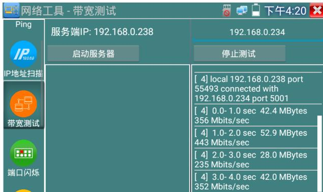
相反，也可以把仪表当服务器，电脑作为测试端（选客户端），填入仪表的IP地址，可以测试网络带宽。
