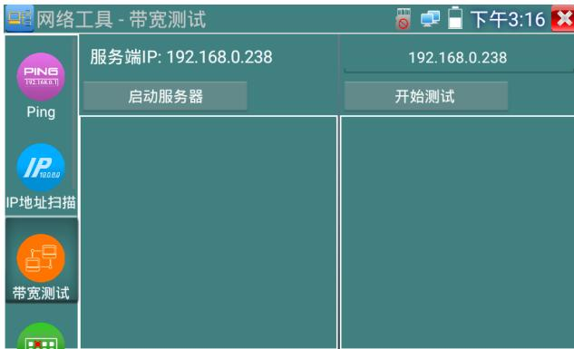
进行网络带宽测试时，必须有一个仪表当服务器或用电脑安装网络测试软件当服务器，另个仪表发包测试。两个测试仪表必须在同一网段上。
