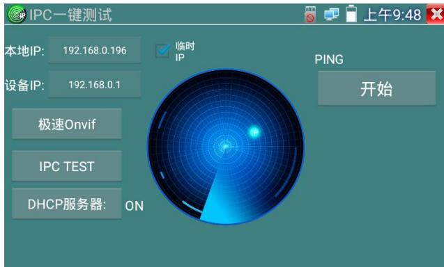
**本机 IP:** 仪表当前的 IP 地址，在搜索到设备 IP 的同时，仪表将自动修改本机 IP 与设备 IP 同一网段。
