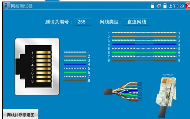
独创 2 芯至 8 芯线路测试，任意两线接通，即可测试显示线序排列、通断情况，以及显示寻线器的编号（默认255）。使用多个不同编号的寻线器，利用测试仪对寻线器编号的读取功能，便于机房线头寻找与排序。随机附送网线测试小盒或寻线器\*（\*定制功能型号见附表）一个。
