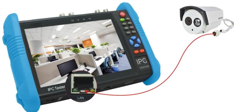
**注：**对于不提供外接电源的IP网络摄像机，因为它只支持PoE供电功能，可通过仪表的LAN端口为该网络摄像机提供PoE供电，供电时必须断开网络交换机与仪表的连接，即仪表的PSE端口不能连接任何网线。
