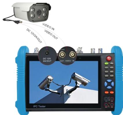
12V供电输出电压大小及功率值，可在PoE电压测量功能中查看。
