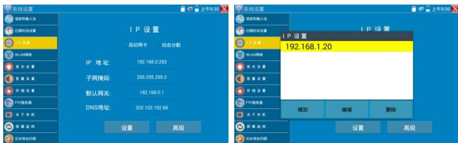
设置上图所示的IP地址后，仪表可以测试192.168.0.0和192.168.1.0两个网段的摄像机。
