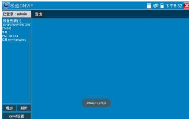
已激活的摄像机，需要登录之后才能进行其他操作。登录时，在左边“在线侦测”栏目选中摄像机，输入正确的用户名密码之后点击“登陆”。
