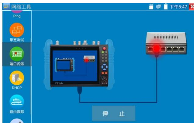
**实用性：**工程人员要检修插在交换机上的网线时，不能随意拔网线，如果拔错线会造成在用网络中断。用仪表在网线的另一端发送信号，对应的交换端口会按固定的频率闪烁，可明显区分其它在用的端口，快速定位该交换机端口，避免工程人员拔错线。
