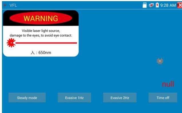
VFL提供四种使用状态——“常亮模式”、“闪烁1Hz”、“闪烁2Hz”和“定时关闭。点击“常亮模式”按钮，VFL进入常开的打开状态；点击“闪烁1Hz”、“闪烁2Hz”按钮，VFL进入闪烁的打开状态；点击“定时关闭”按钮，VFL立即关闭，可选择定时关闭时间。（时间有：5分钟、10分钟、30分钟、60分钟、120分钟。）用户可根据实际使用情况进行操作。
