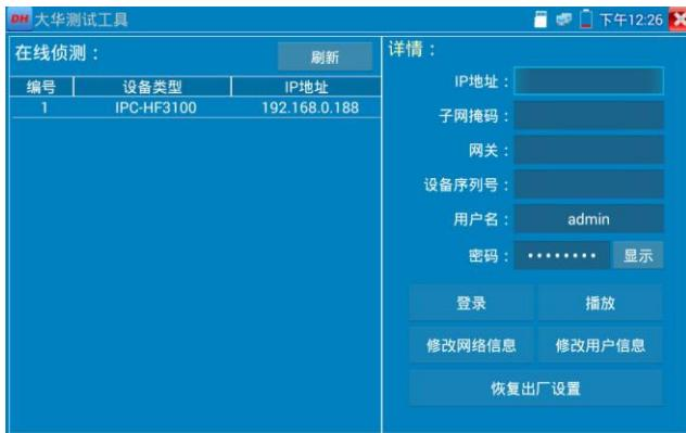
选中“在线侦测”栏目中的摄像机，如果摄像机支持非验证方式登陆，无需登陆，直接点击播放，可观看摄像机图像。
