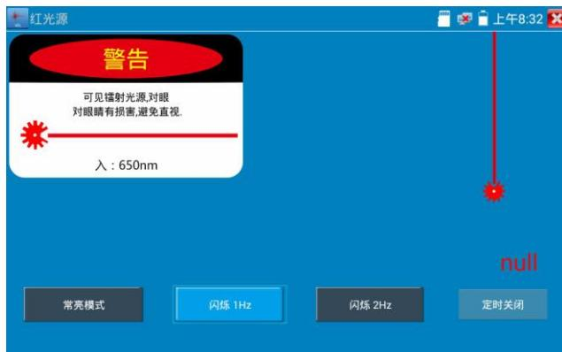
在主界面将VFL功能打开后，点击“闪烁1Hz”或“闪烁2Hz”按键，则VFL进入脉冲发光模式，红光按一定频率发出。再次点击该按键可退出测试。
