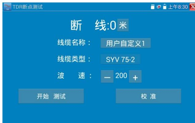
1. 在线缆名称中选“用户自定义1”，点击右下方的“校准”按钮仪表进入校准界面，点击“用户自定义1”可自行定义线缆名称，如：爱谱BNC-5。
