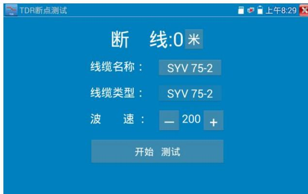
仪表内置BNC线缆、网线、RVV控制线、电话线、TVVB电梯视频线等线缆测试选项。用户可自行定义11组校准线缆类型。
