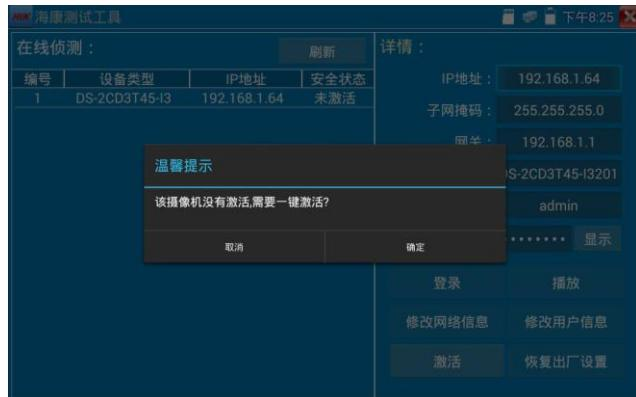
**2. 输入激活密码：**按要求输入新的密码，点击“确定”可激活摄像机。
