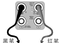
注意：被测电阻应该单独测量，而不是在安装电路中测量。测量线路时，被测线路应该断电。
