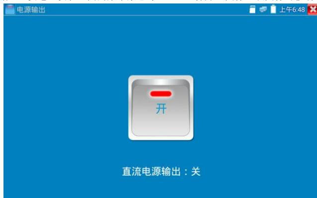
仪表直流电源输出开启，退出电源输出界面后，PoE电源处于开启状态，仪表上面的菜单条一直悬浮“48V已打开”，直到仪表休眠或进入电源输出功能界面点击关闭电源输出。
