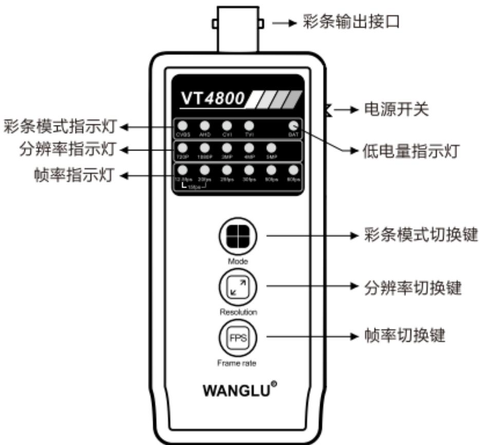
请使用两节5号电池供电，安装时注意正负极。
